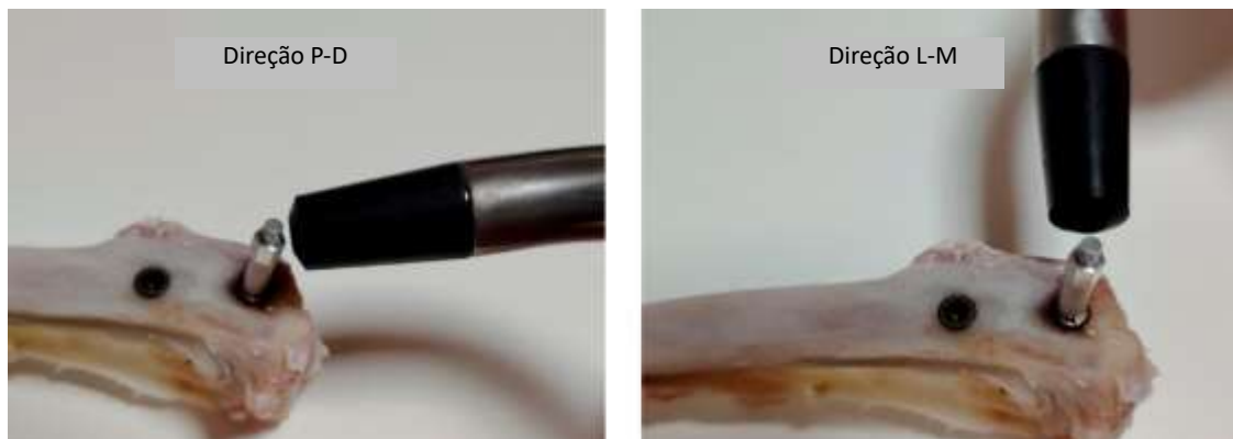
Figura 5. Medições da estabilidade do implante utilizando o sistema Osstell em duas direções (proximodistal (P-D) e lateromedial (L-M)).
